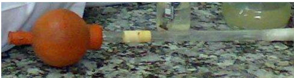
تصویر ۱-۲- شمای کلی پوآر برای سیفون کردن نمونه زئوپلانکتون
