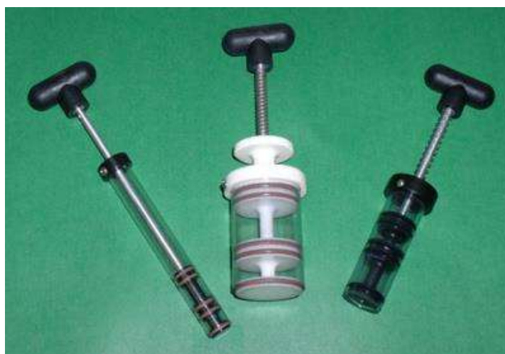
تصویر ۲-۲- شمای کلی پیپت استمپل (stemple pipette) برای برداشت نمونه زئوپلانکتون جهت شمارش
